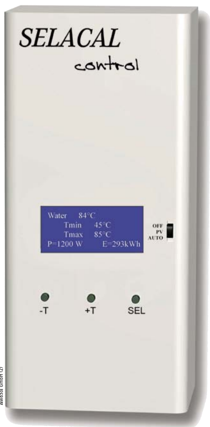
Zentrale: Der »Selacal Control«-Regler hält das System im optimalen Arbeitspunkt für die jeweils verfügbare Photovoltaikleistung und dient zur Konfiguration sowie zur Fehlerdiagnose.
